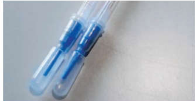
Figure 2. Écouvillons pour effectuer la collecte d'échantillons à analyser avec l'ATP-mètre
